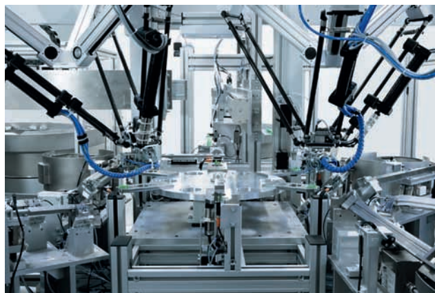
› Slika 2: Tripodni robotski sistemi kot predhodno sestavljena visokohitrostna rešitev za rokovanje z materialom s hitrostjo do 150 ciklusov na minuto (foto: Festo)
