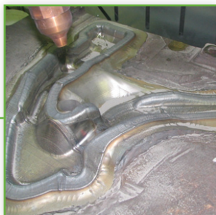
Laserska tehnologija LENS – veliki potencial za izboljšanje orodij za brizganje plastike
