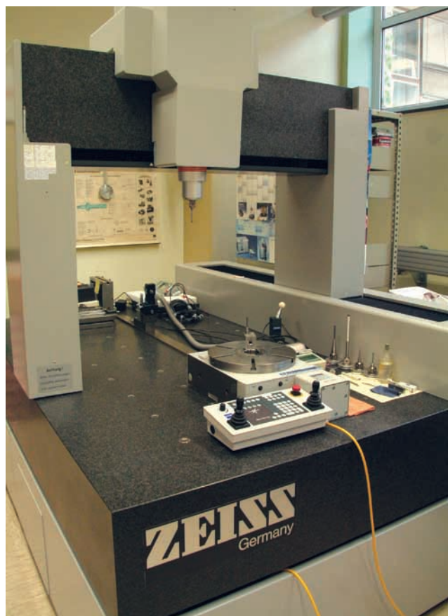
► Trikoordinatna merilna naprava v Laboratoriju za tehnološke meritve na Fakulteti za strojništvo v Mariboru
