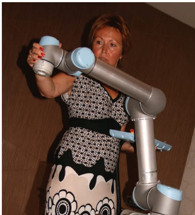
› Svetlana Vinogradova, področni vodja prodaje pri podjetju Universal Robots, je na predstavitvi nazorno pokazala preprosto upravljanje robota UR 5, ki je namenjen predvsem za uporabo odvzemi in odloži (angl. pick and place), uporabljajo pa ga tudi za druge naloge v industriji.
