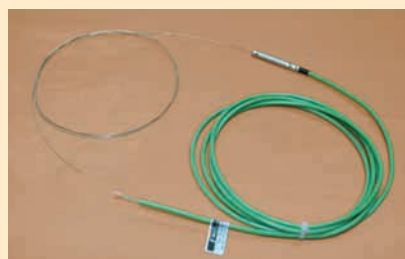
» Tipalo s priključnim kablom
