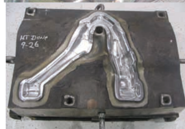
► Slika 2: Tehnologija omogoča izdelavo obrabno obstojnih površinskih slojev (trdih prevlek) za obnovo oz. podaljšanje življenjske dobe orodij.
