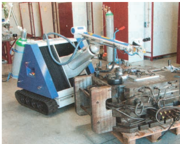
» Premična izvedba ALFlakovega fleksibilnega laserja za reparaturno varjenje gravur z dodajanjem materiala (slika: ALF.jpg)
