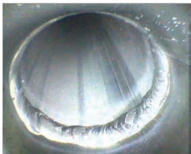
» Slika 2: Pregled zvarov je samo ena od možnih uporab slikovnega endoskopa »Top Line«.
