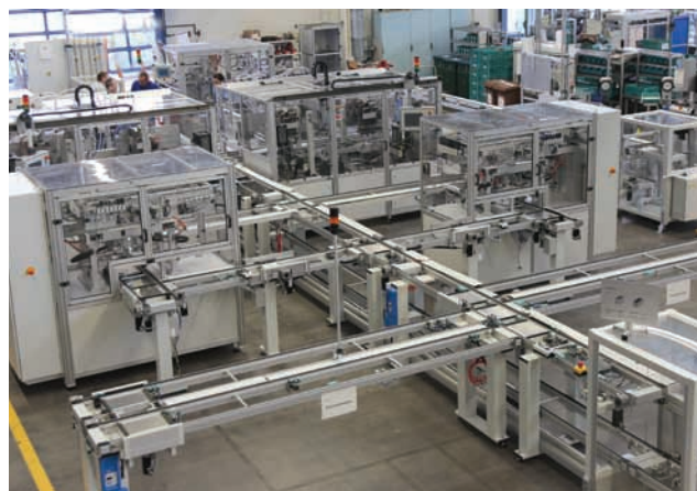
► Slika 4: Nova avtomatizirana linija za sestavljanje kompaktnih delovnih valjev ADN/ADVU, ki so jo izdelali v Festu in ima zmogljivost do 850 000 izdelkov v povprečnem taktu 20 sekund (Foto: Festo)
