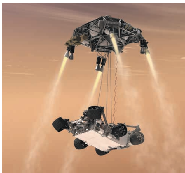
› Slika prikazuje manever »skycrane« (slov. nebeško dvigalo), s katerim se rover spušča proti površju.
