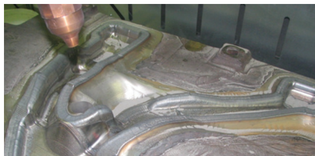
► Slika 2: Tehnologija omogoča izdelavo obrabno obstojnih površinskih slojev (trdih prevlek) za obnovo oz. podaljšanje življenjske dobe orodij.
