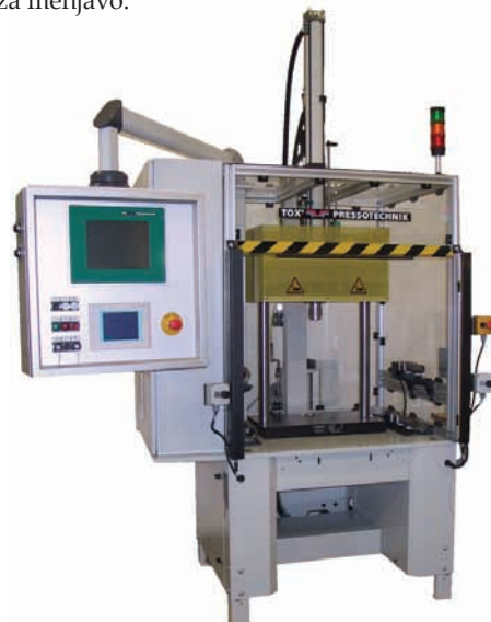
» Dvostebreno stiskalnico MBG v kompaktni izvedbi z dvema ploščama odlikujeta velik delovni prostor in možnost različnih pogonov. Izvedba na sliki je opremljena s pnevmohidravličnim pogonom KT z ločenim pogonskim delovnim valjem in ojačevalnikom tlaka.
