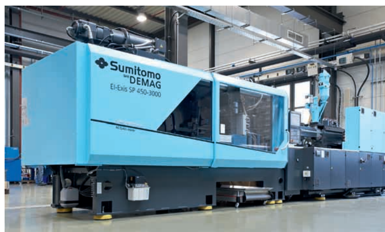
› El-Exis SP: hitri stroj, ki izkorišča prednost novega hitrega stranskega vstopa enote z IML
