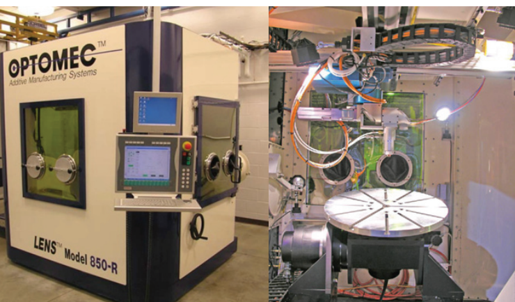
► Slika 1: LENS™ omogoča izdelavo zahtevnih unikatnih izdelkov, navarjanje različnih kovinskih prahov, izdelavo prototipov in obnovo strojnih delov.
