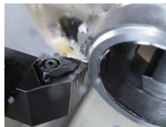
» TK1001/TK2001 Duratomic ploščice za povečanje življenjske dobe orodja in povečano produktivnost
