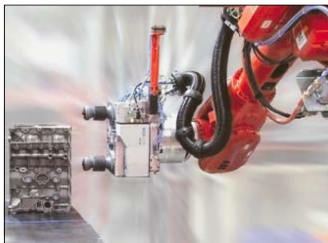
Slika 14. Primer uporabe IVC-3D kamere
