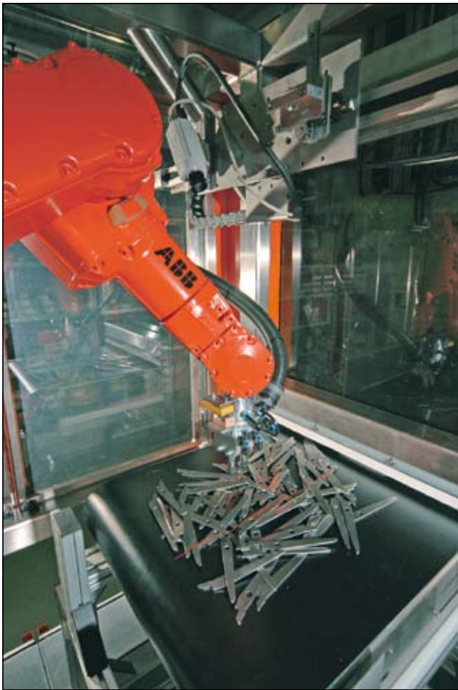
Slika 16. Določanje 3D položaja predmetov pri pobiranju
