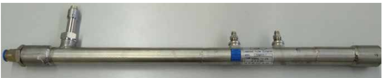
Slika 1: Laminarni tokovni element z vgrajenim temperaturnim zaznavalom (na levi)
