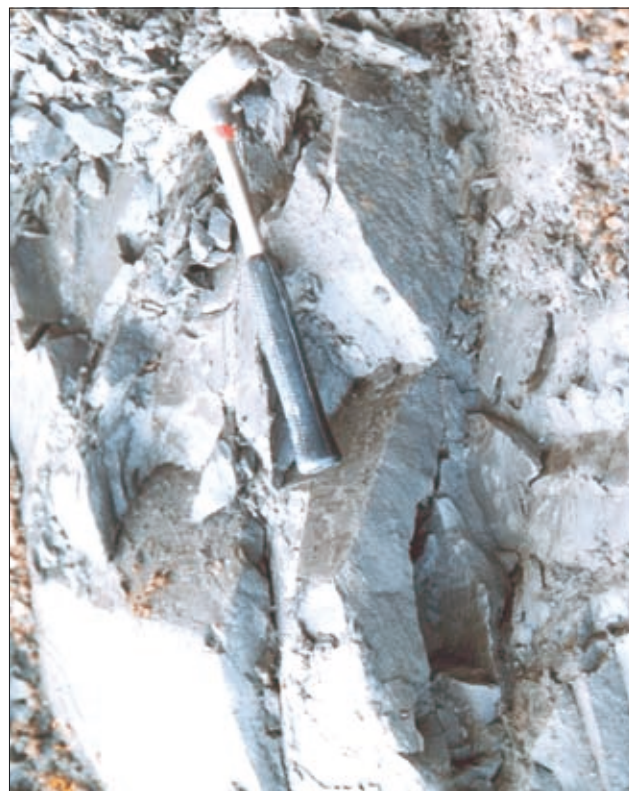
Sl. 7. Nabrekanje in odpiranje razpok v sivici zaradi gradienta sukcijske, avtocestni vkop pri Vranskem v letih 1996–1997, sveže odkopana brežina. Predhodne geološke raziskave niso opozorile na možnost nabrekanja.
