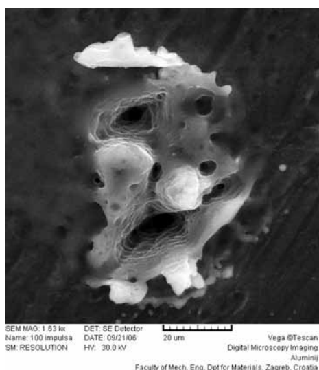
Figure 5: The target after 100 pulses (central part of damage) (SEM) Slika 5: Tarča po stotih impulzih (najbolj poškodovano območje) (SEM)
