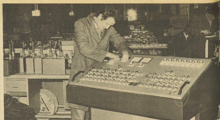
Montaža stikalnih naprav.
