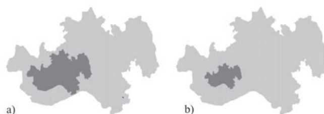
Slika 5: Razmerje med površino občine Ormož in letno potrebo po glini za izdelavo opeke porabljene na območju Slovenije a) klasična opeka; b) modularni blok.
