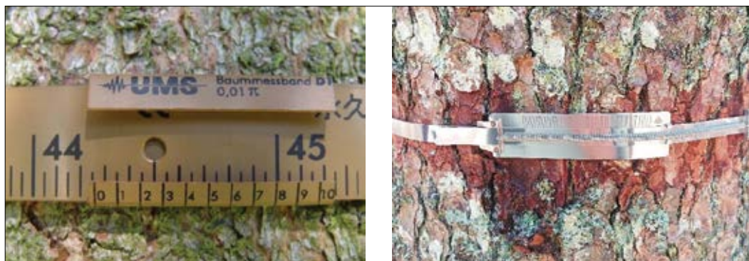
Slika 1: Spremembe v premeru debla odčitavamo na desetinko milimetra natančno, kar omogoča nonijska skala. Na sliki levo je ročni dendrometer nemškega proizvajalca UMS München, ki kaže absolutne spremembe premera, na sliki desno pa ročni dendrometer češkega proizvajalca EMS Brno, ki kaže spremembo obsega, premer pa moramo izračunati posebej
