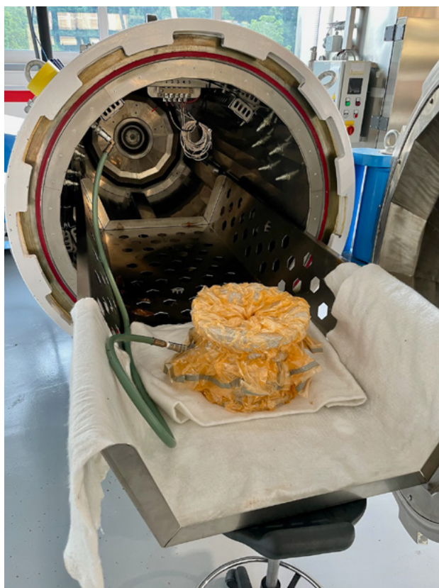
Slika 3: Utrjevanje kompozitnega materiala v peči avtoklav
