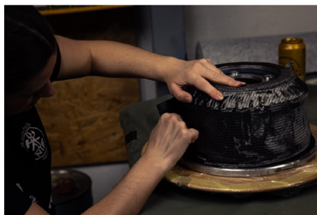
Slika 2: Izdelava platišča z materialom VTC401 CBX245 \pm 45 - 42 % RW
