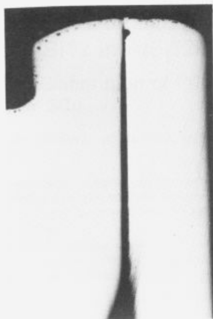
Slika 5. Prerez laserskega zvara v primeru, ko varimo brez bakrenega kvadra. Parametri laserskega varjenja: 20 Hz, 3 J, 12 ms. Jedkano z nitalom, 100 ×.
