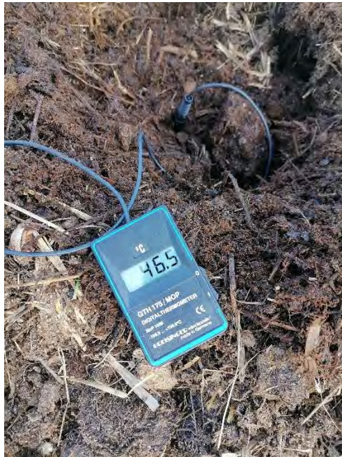
Slika 5: Merjenje temperature kompostnega kupa (vir: lastni, 2023)
