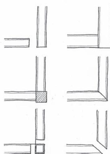
**Slika 6.** Kotni spoji plošč. Spoje je treba pustiti odprte, ali jih zaščititi z lesenimi oziroma kovinskimi profili (levi stolpec). Spoji na desni strani so nepravilni: treba se je izogibati topih spojev in ostrih robov lesnih plošč.
