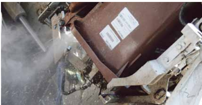
Na posebni hidravlični roki so tri šobe, ki operajo zaboynike s 140 bari pritiska.
