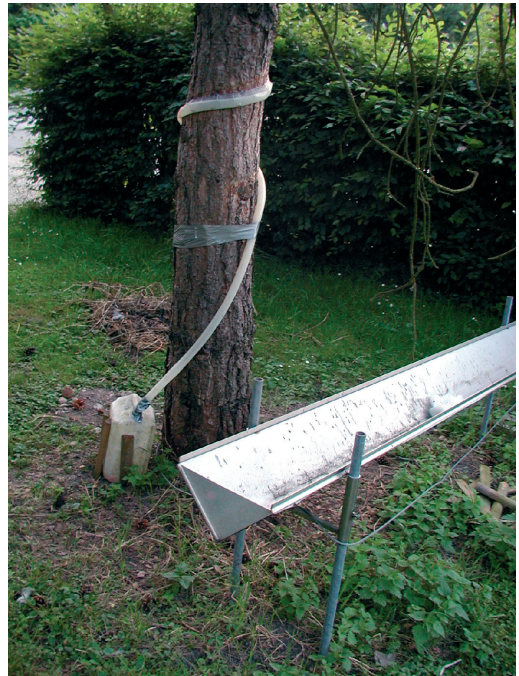
Slika 4. Merjenje odtoka po deblu (levo breza, desno bor) Figure 4a: Stemflow measurement (left Betula pendula Roth., right Pinus sylvestris L.).
