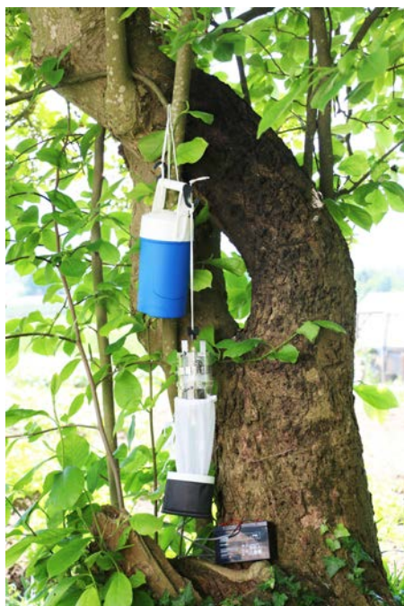
Past za lov odraslih komarjev in peščenih muh tipa CDC Light Trap , ki kot vabo uporablja lučko in CO 2 , ki se sprošča v okolje med taljenjem suhega ledu iz termovke. (foto: Tea Knapič)
