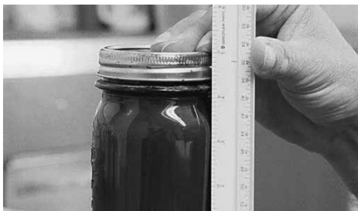
Slika 3: Izmerimo višino posameznih plasti usedlin (foto A. Vovk Korže, 2012).
