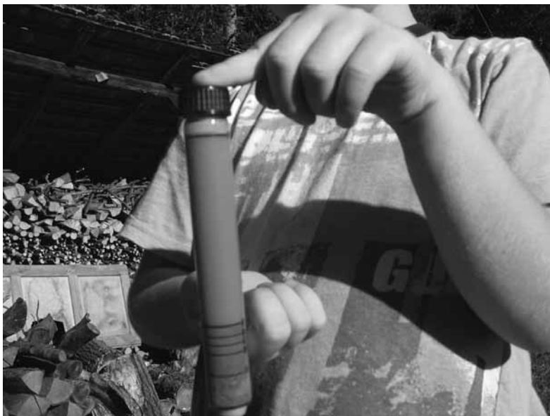
Slika 4: Usedanje prstenih delcev po 18 sekundah (foto: A. Vovk Korže, 2010)
