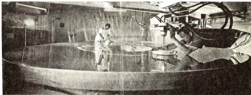
Sl.1 Brušenje teleskopskega zrcala s premerom 4 m
