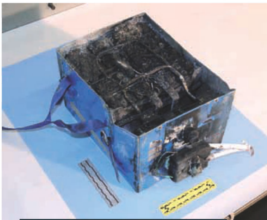
Litijske baterije večinoma ne smemo uporabljati nad 3000 metri nadmorske višine. Na sliki je uničena letalska akumulatorska baterija.
