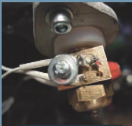
Mali termistor ob šobi. Seveda ne dela, ker je počil lot.
