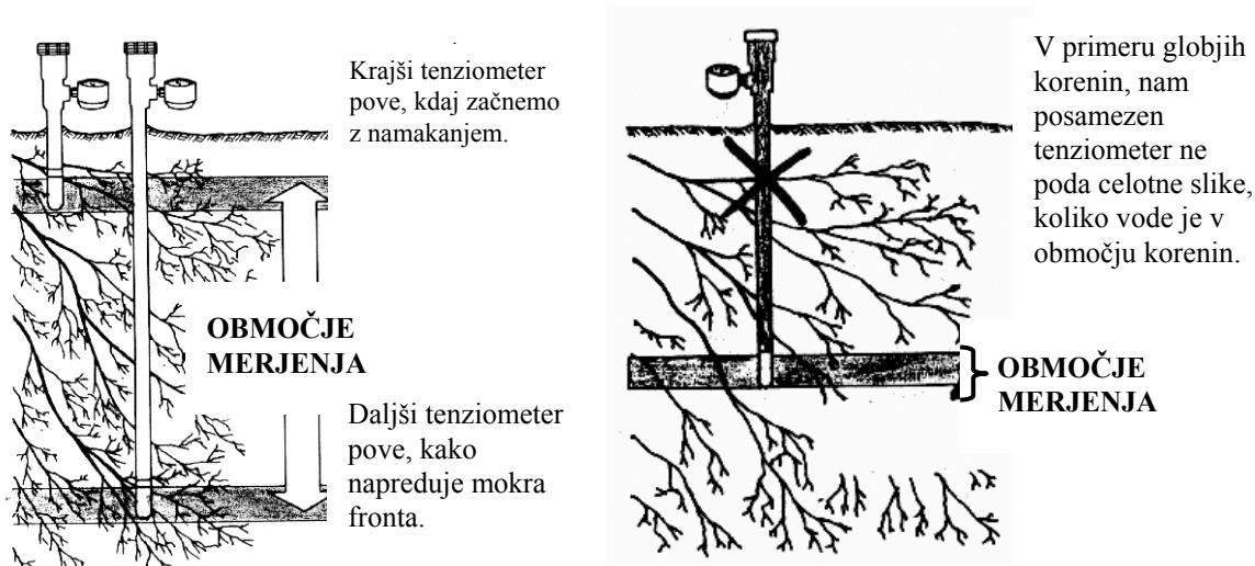
Slika 6: Uporaba tenziometra z dvema oz. posameznim tenziometrom na merilno mesto (levo pravilno, desno nepravilno)
