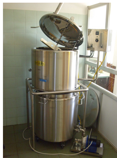
Nova varilnica proizvajalca Labu Buchrucker GmbH s kapaciteto 130 L. (foto: I. J. Košir)
