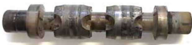
Slika 12 : Krmilni bat AIDRO ventila HD3-AMPS-1PC-R4/10 po 2 000 000 ciklih
