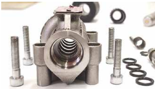
Slika 7 : Ohišje s pritrdilnimi vijaki AIDRO ventila HD3-AMPS-1PC-R4/10 pred začetkom trajnostnega preizkusa z vodo
