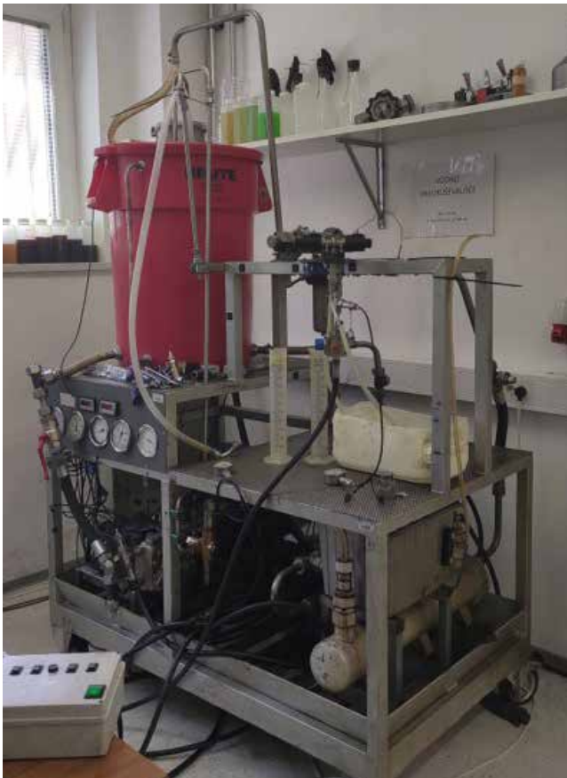
Slika 2 : Vodno preizkuševališče za prvo merjenje notranjega puščanja
