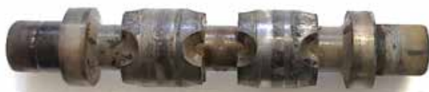
Slika 15 : Krmilni bat AIDRO ventila HD3-AMPS-IPC-R4/10 po 3 390 000 ciklih pred čiščenjem
