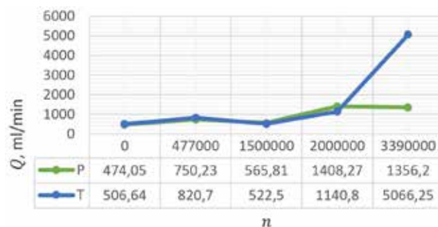
Slika 18 : Spreminjanje notranjega puščanja vode skozi AIDRO-v proporcionalni potni ventil v odvisnosti od opravljenih ciklov s tlakom 300 bar na vodu B
