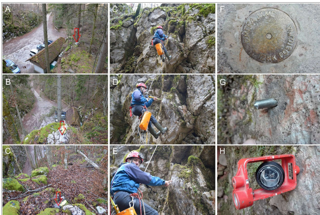
Slika 2 – Stabilizirane stojiščne točke nad parkiriščem pred vhodom v Križno jamo, iz katerih je bil opravljen del meritev, in sicer (A) stabilizirana točka 100, (B) 101 in (C) 102. Slike Č-E prikazujejo postopek fiksacij točk na (1L-4L) in v neposredni okolici (1S-4S) potencialno nestabilne skalne gmote. Slika F prikazuje detajl načina stabilizacije stojiščnih točk 57 in 58, slika G detajl načina fiksiranja točk 1L-4L, 1S-4S, 100, 101 in 102, slika H pa točko 1S v času meritev z mini prizmo.
