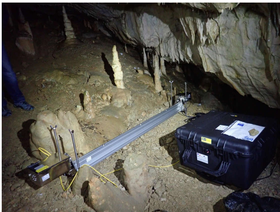
Slika 1 – Laserski diodni spektrometer za merjenje koncentracij metana, Lepe jame, Postojnska jama, foto S. Šebela.
