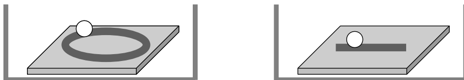
Slika 3: Prikaz različnih obrab in načinov gibanja na tribokorozijskih sistemih: a) pin-on disc tribokorozijska obraba in b) linearna dvosmerna ( angl. Reciprocating) obraba
