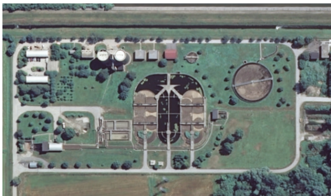
Slika 20 • Namesto da bi za pogon č. n. z izgradnjo male HE na jezu v Markovcih izkoristili 3000 kW vodne moči, so za manjšo porabo energije opustili denitrifikacijo (črni del). Namesto male HE pa na č. n. zgradili dražjo bioplinarno za le 180 kW.
