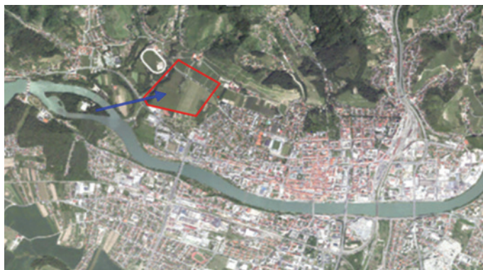
Slika 28 • Zajem obrežnega filtrata Drave iz 4 vodnjakov na Mariborskem otoku za bogatenje in aktivno zaščito podtalnice pred vplivi mesta na Vrbanškem platoju (Rismal, 2018).
