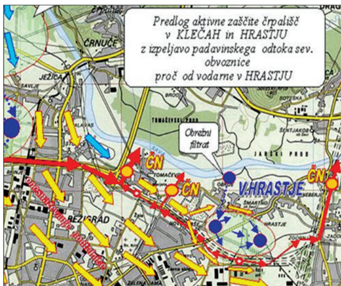
Slika 33 • Vodnogospodarsko in ekološko podprti načrt za bogatenje in istočasno zaščito pitne podtalnice vodarne v Hrastju s filtratom Save pred severno obvoznico in onesnaženo podtalnico izpod mesta (Rismal, 1999).
