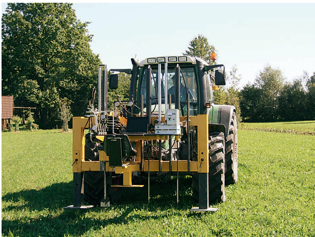
Slika 6: Bevameter s penetrometrom, naprava za merjenje specifičnega upora tal in strižne trdnosti tal
