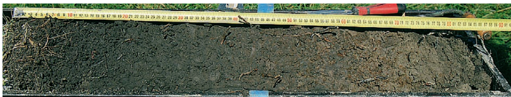
Slika 4: Talni profil – izvrtina mehkih organskih šotnih tal
