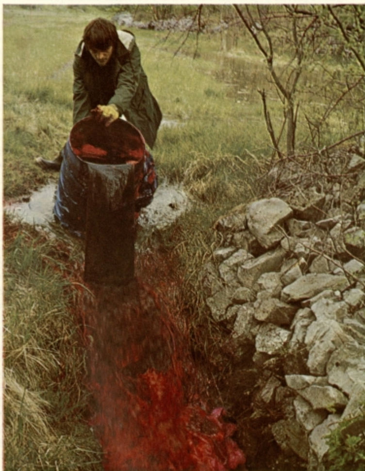
Fig. 16. Traçage des eaux pompés du puits VB-4/79 qui disparaissent dans la perte près de Klariči à la distance de 1000 m du puits
