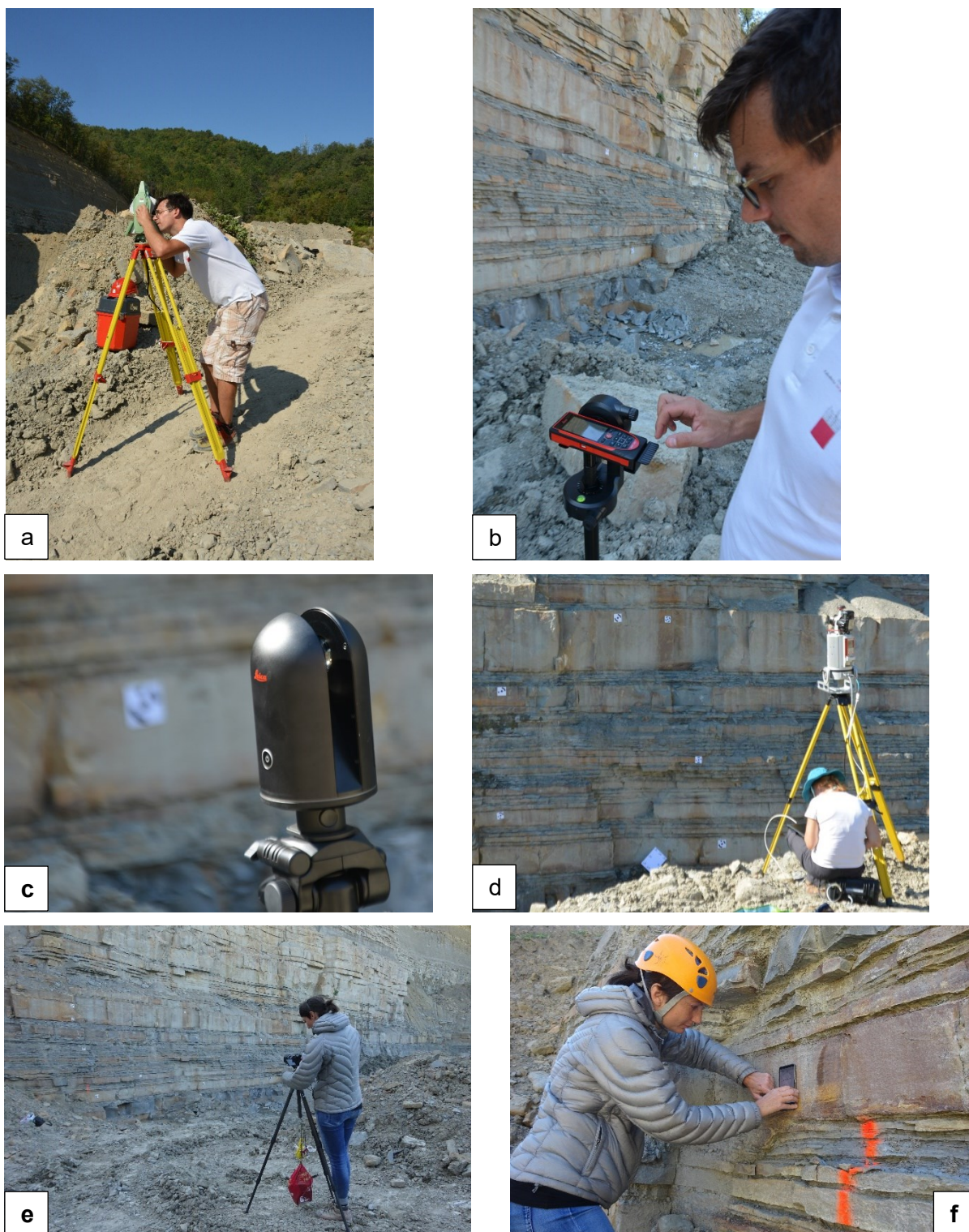
Slika 4.9: Pregled uporabljenih instrumentov za zajem izkopnega čela v kamnolomu Elerji pri geometrični analizi. Opisi (a–f) so predstavljeni v besedilu.
