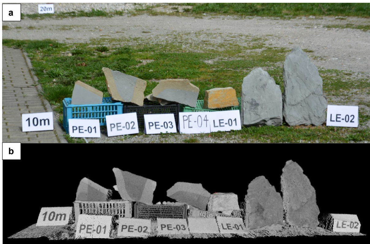
Slika 4.1: Detajlno terestrično lasersko skeniranje vzorcev kamnin fliša: a. Pogled na izbrane vzorce peščenjaka (PE-01 do PE-04) in laporovca (LE-01 in LE-02), odvzetih v kamnolomu Elerji; b. Posnetek laserskega skeniranja vzorcev. Vzorci so bili skenirani na razdaljah 5 m, 10 m, 20 m in 25 m, v suhem, vlažnem in mokrem stanju. Skeniranje se je izvedlo s skenerjem Riegl VZ-400.
