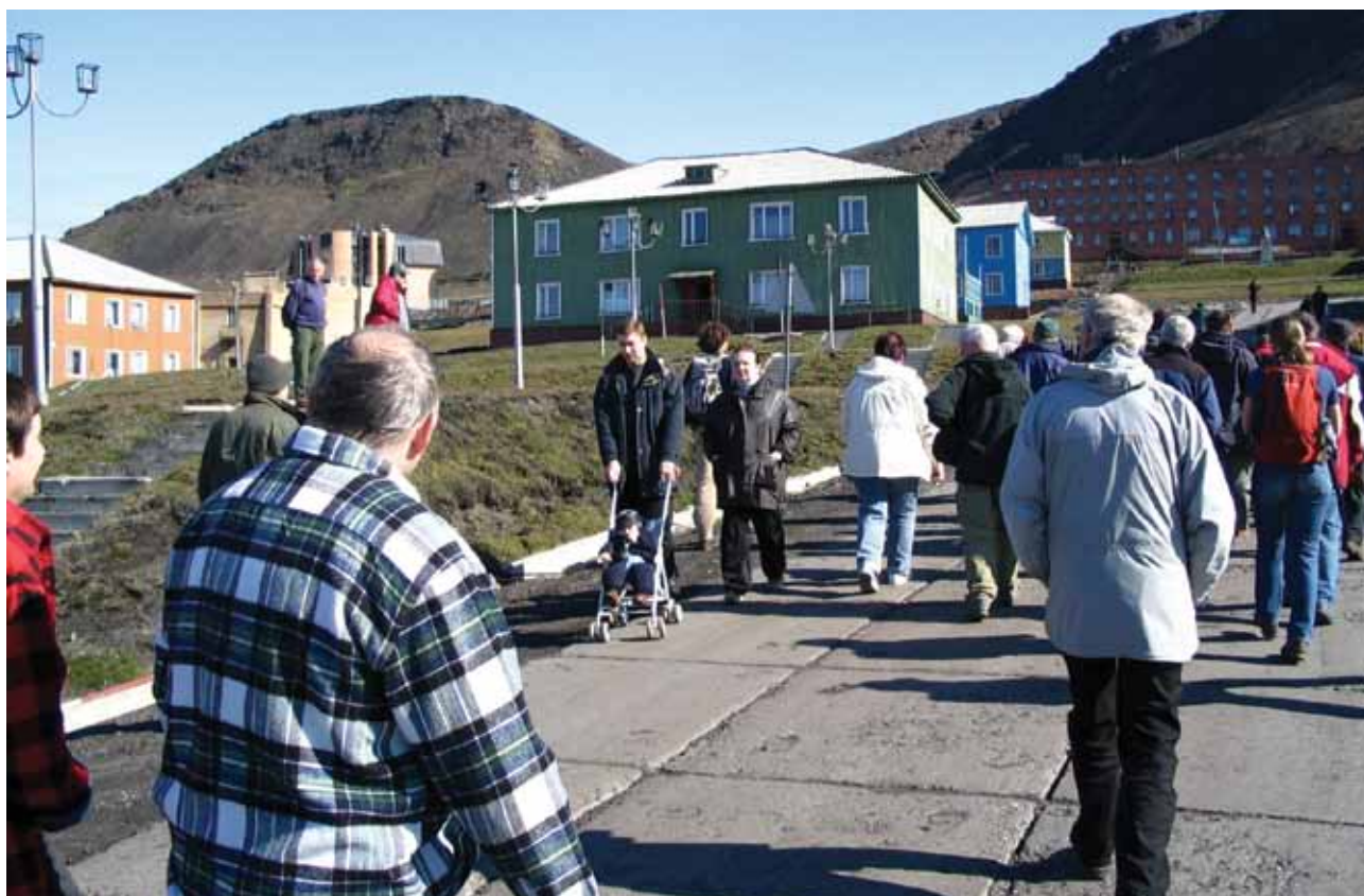
Slika 5: Prizor iz Barentsburga, ruske enklave na Spitsbergenu, kjer so tla zaradi nestabilnosti, ki jo povzroča permafrost, tlakovana z betonskimi ploščami (foto: Jurij Kunaver).
