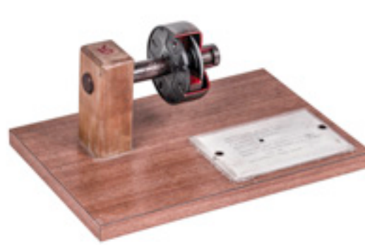
Model izuma in dopolnitve izuma centrifugalne sklopke. Tehniški muzej Slovenije. Foto: Dragan Arrigler.
