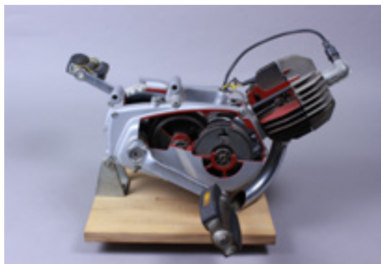
Prerez motorja Tomos Avtomatik A3. Tehniški muzej Slovenije. Foto: Jaka Blasutto.
