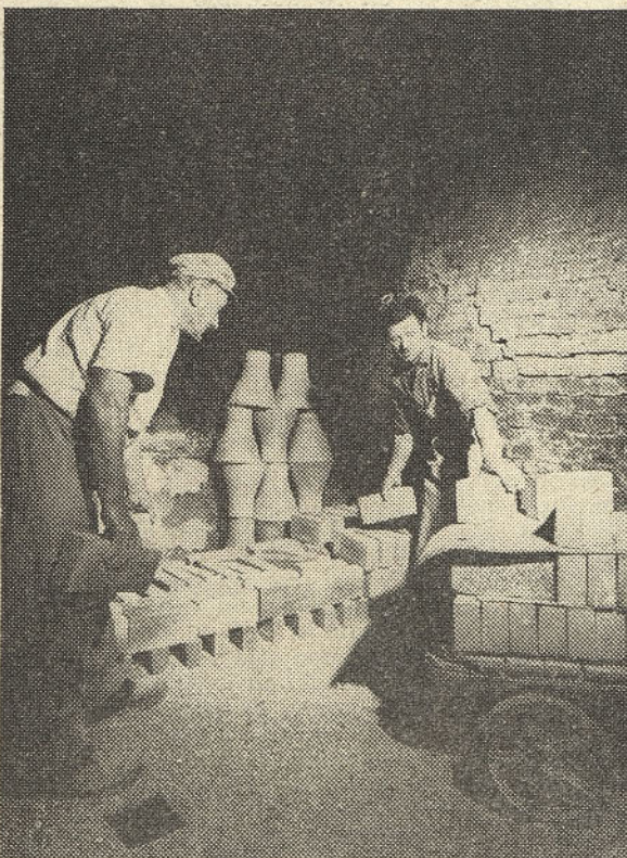
Samotarna — nakladanje žgane opeke v peči
