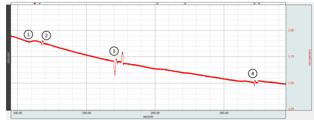
Slika 6: Kontrolna meritev premika roke, na kateri so nameščene elektrode za merjenje prevodnosti kože: 1) premik roke, 2) striženje s prsti, na katerih so bile nameščene elektrode, 3) trzljaj z dvigom roke, 4) majhen trzljaj roke.
