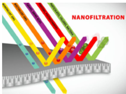
Slika 5: Nanofiltracija. (Vir: Synder Filtration, 2024.)
