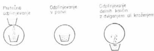
Slika 4 — Osnovni postopki odplinjevanja jekla
