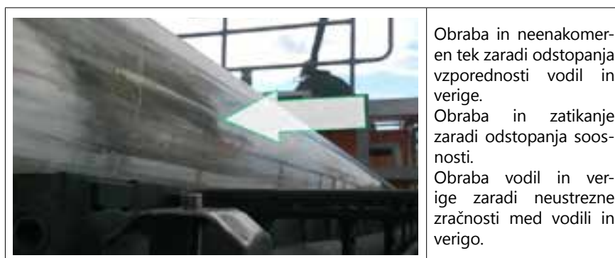
Slika 3. Poškodbe vodil in druge napake
