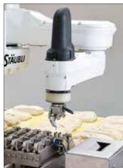
Razrez izdelkov iz testa z robotom Stäubli
