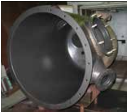
Slika 1. Posoda, zaščiten s prevodno oblogo E-CTFE
