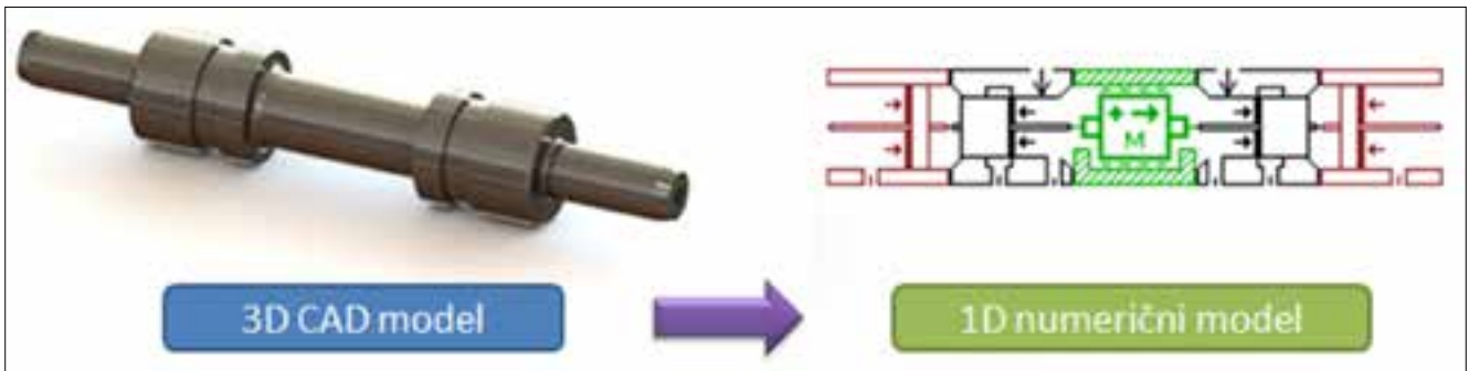
Slika 10. Diskretni 1D-model krmilnega bata z ozirom na 3D-model
