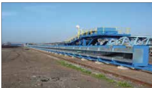
Slika 7. Najdaljša energijska veriga s hodom 615 m v termoelektrarni Tušimice II
