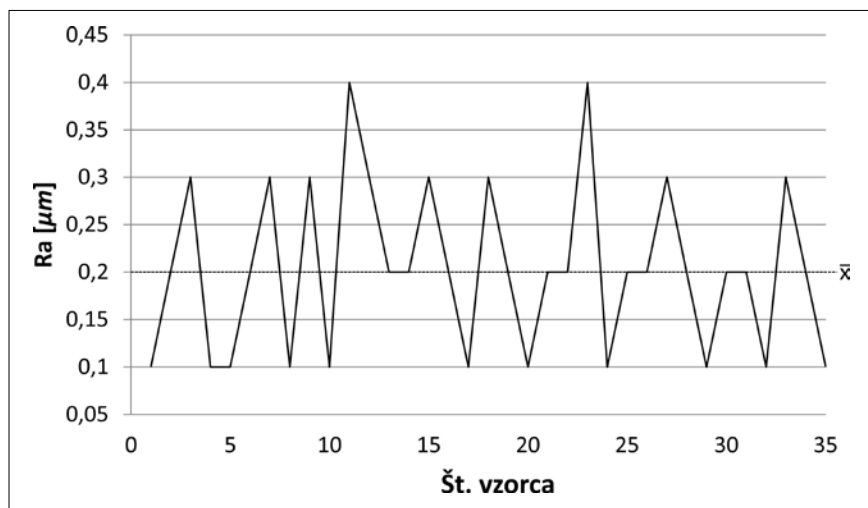
Slika 9. x-kontrolna karta hrapavosti površine Ra: potrditveni test
