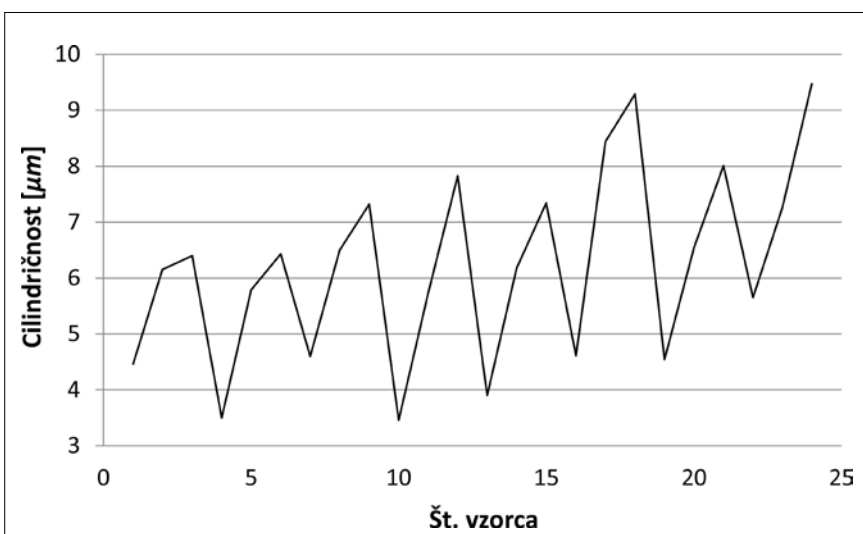
Slika 3. x -kontrolna karta cilindričnosti: prikaz pomanjkljivosti vpenjalne naprave
