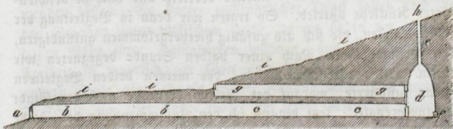
a Eingang. hb gewölbter und cc flach bedeckter Theil des untern Ganges. d. Kegelförmiges Brunnenhaus. e. Senkrechter Schacht der sich bei h mündet. f. Die Quelle. gg. Oberer Gang, zur Herstellung des Luftumzuges. iii. Äußere Hügelfläche.
