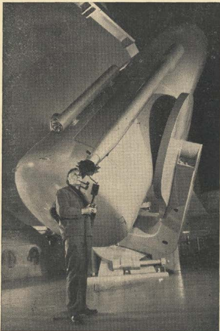
Ogromni teleskop na gori Palomar v Kaliforniji, katerega zrcalo tehta 20 ton in ima 5 metrov premera. Z njim prodrejo v vesemirjev globino 1,000,000,000 svetlobnih let.
