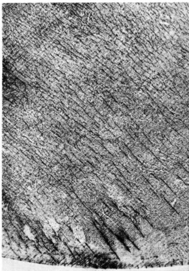
Slika 28 Brusilne razpoke na osnovni ploskvi noža, pov. pribl. 2\times
