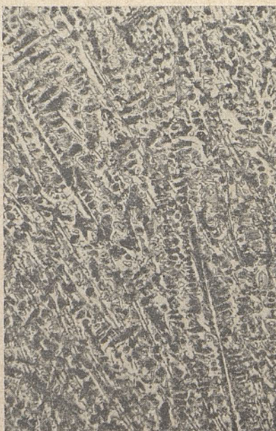
Slika št. 5: Tablice za količino cementita, oziroma količino bele strukture v nodularni litini
