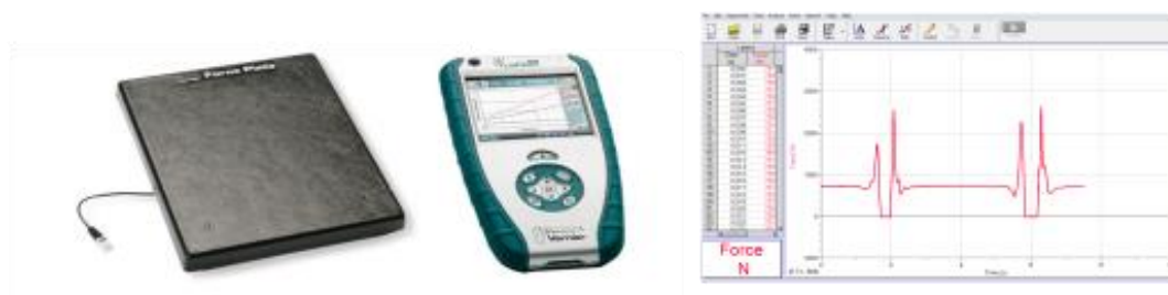
Slika 1: tehtnica za merjenje sil – Force Plate, Vernier Labquest – vmesnik za priključitev tehtnice na računalnik in zaslonska slika dveh navpičnih skokov v programu Logger Lite 1.4
