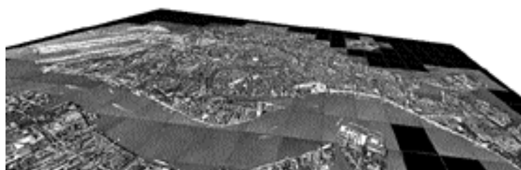
Slika 3: Perspektivni pogled fotokarte Benetk, pridobljen z uporabo projektivne transformacije
