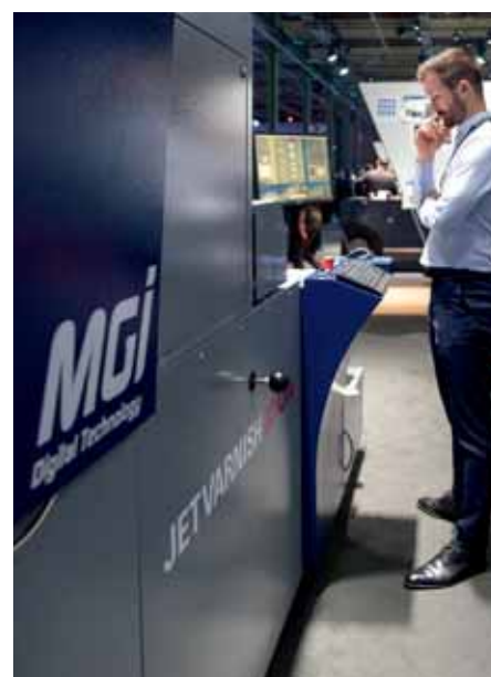
MGI Jetvarnish 3D One omogoča digitalno lakiranje polnih ali delnih površin digitalno ali ofsetno natisnjenih tiskovin.
