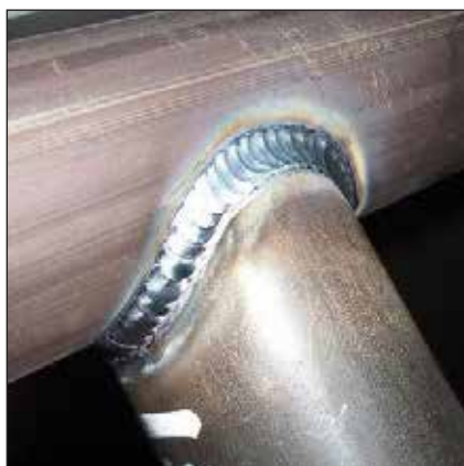
Slika 3. Ročno varjen priključek cevi na cev po postopku TIG utripno, brez obrobnihih zajed, visoke kakovosti in lepega videza
