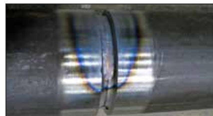
Slika 2. Varjenje korenskega varka na steni dveh cevi je pogosto treba izvesti ročno obločno z oplasčeno elektrodo ali pa s postopkom TIG, kot je prikazano na sliki.
