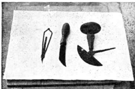
Z desne proti levi: Tako so se spreminjali noži za vrezovanje. Prvi nož je »linkavc«
