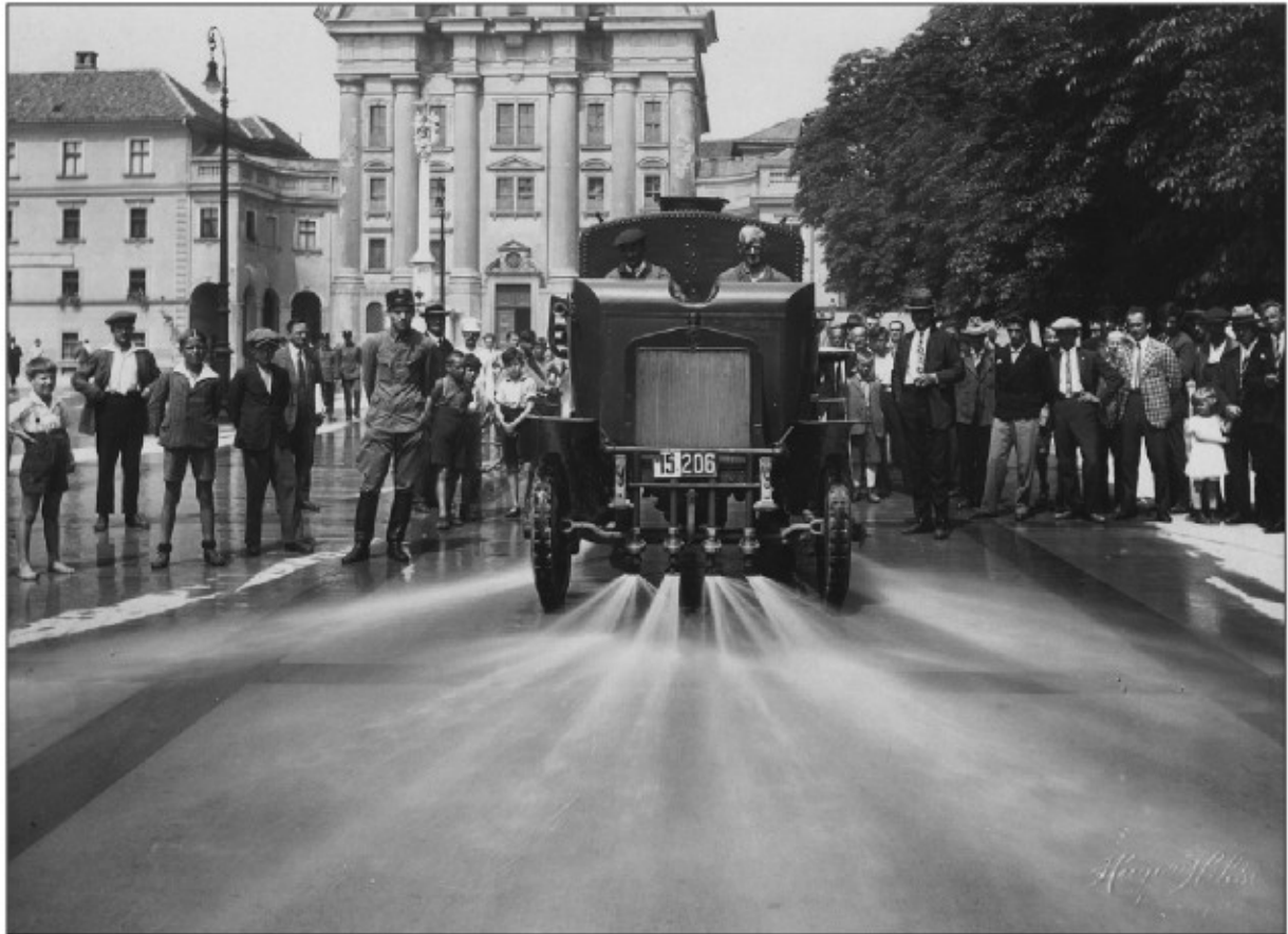
Škropilni avto Mestne občine ljubljanske na Kongresnem trgu, demonstracija pranja cestišča, okoli 1930 (ZAL, PozII/A, 128).
