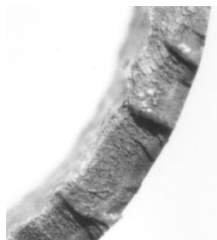
Figure 4: Fatigue crack surface Slika 4: Površina utrujenostne razpoke
