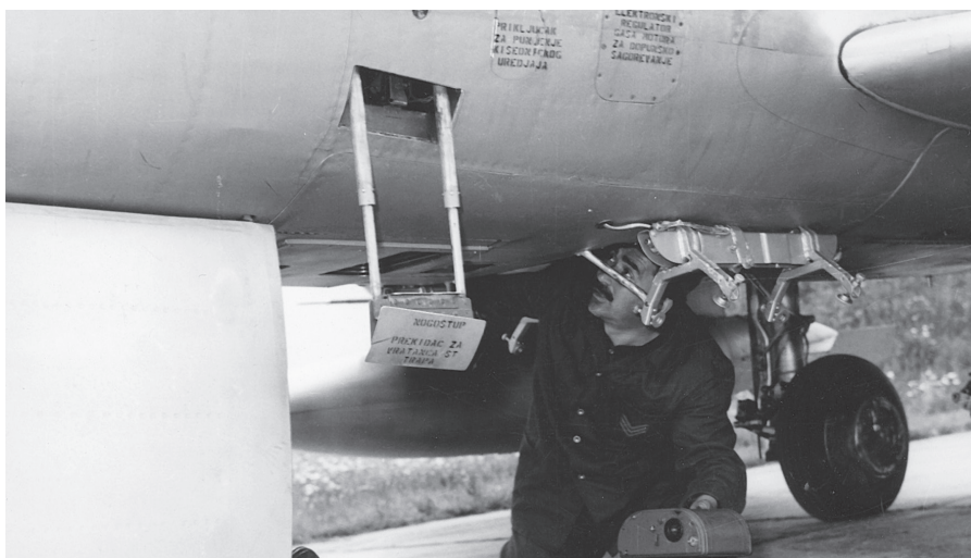
Dostop do kamer K-24 je bil na spodnji strani trupa na mestu, kjer so bile pri lovsko-prestrezniški različici v zabojniku nameščene rakete. Tehnik v rokah drži ohišje kamere. Na sliki je dobro viden tudi nosilec za bombe FOTAB in SAB, s katerimi so si pri izvajanju nalog pomagali izvidniški piloti. (Foto: posredoval Bojan Dimitrijević)
