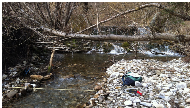
Slika . Suhodolnica, hidrometrična meritev na odseku VM09 (pod odvzemom za MHE in na mlinščici Suhadolnice)
