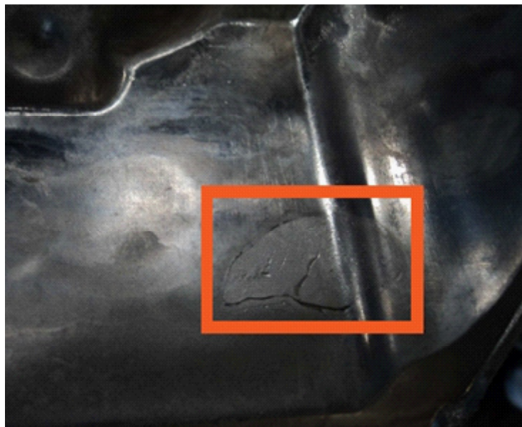
Slika 3: Hladni zvar pri klasični konstrukciji zračenja
