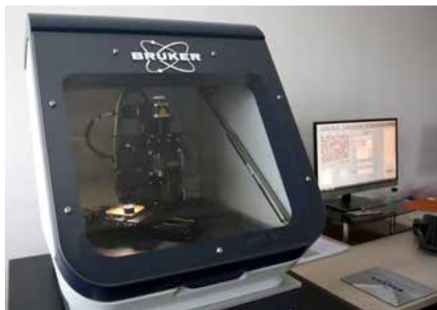
Slika 2 : Napreden nanomehanski sistem Femto-Indenter FT-I04 (Foto: Arhiv FS)
