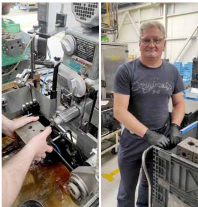
Sliki 3 in 4 : Ročno honanje in Radovan Markovič, ki v proizvodnji ventilov obvladuje procese honanja. (Foto: arhiv PH)
