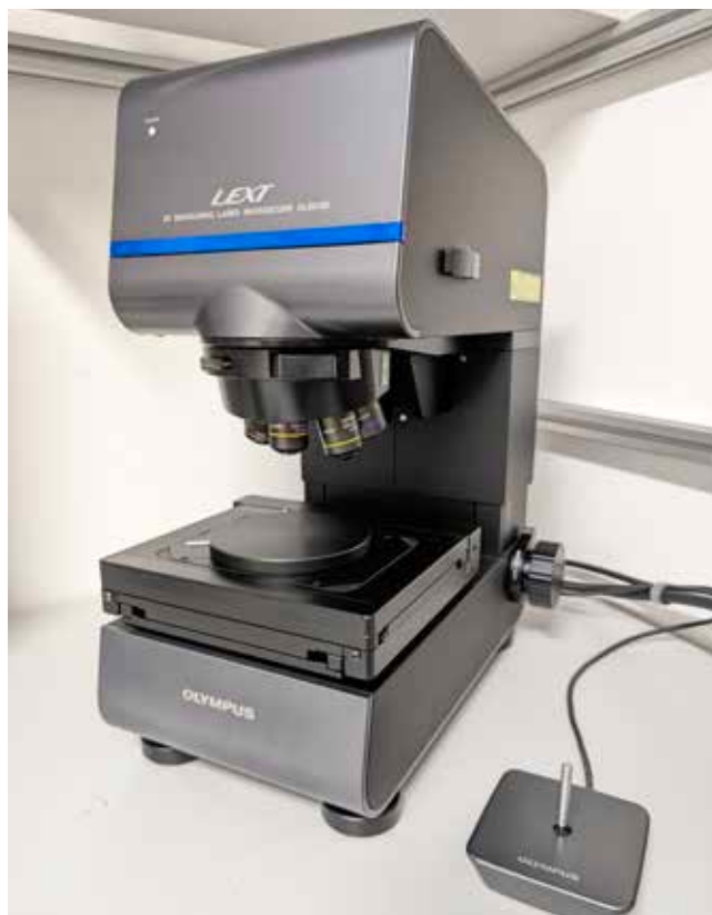
Slika 3 : Optični analitski sistem za meritve površin v vakuumu (Foto: Arhiv FS)
