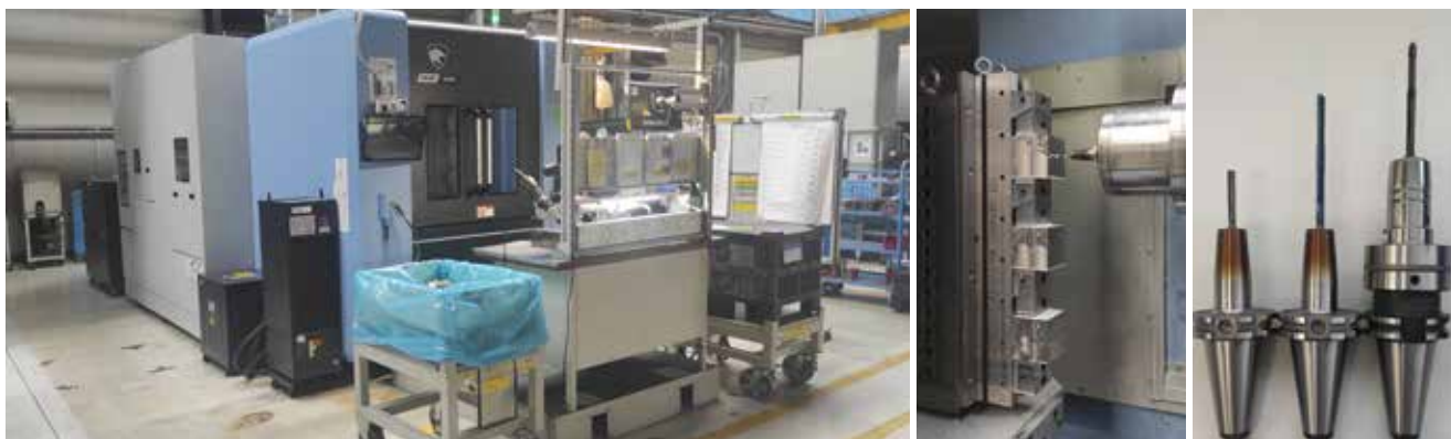
Slika 6-8 : Obdelava v CNC obdelovalnem centru in set novih orodij za avtomatsko obdelavo batnih izvrtin (Foto: arhiv PH)
