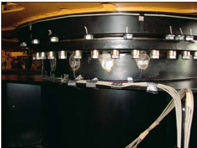
Meritve z merilnimi lističi na podvozju bagerja
