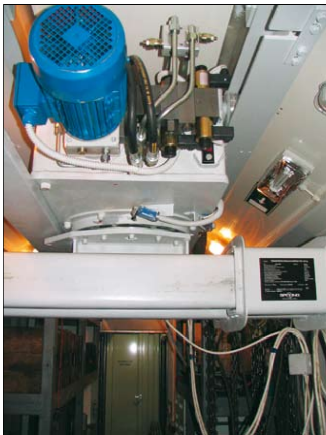
Hidravlični agregat prevoznega teleskopskega dvigala (detajl)
